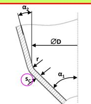
Spojení dvou kuželových skořepin Joint of two conical shells
