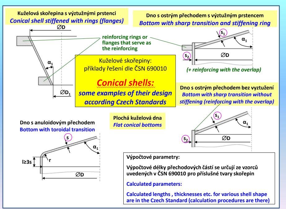
Spojení kuželové a válcové skořepiny s výztužným prstencem Joint of conical and cylindrical shells with stiffenig ring
