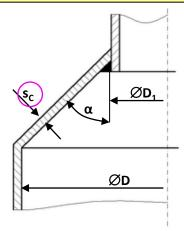
Spojení kuželové skořepiny s válcovou skořepinou menšího průměru Joint of conical shell with cylindrical one of smaller diameter
