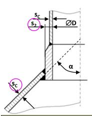
Základní rozměry kuželového přechodu Basic dimensions of conical transition
