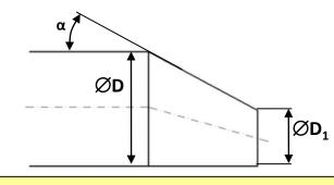
Spojení s nesymetrickou kuželovou skořepinou Joint with non-symmetrical conical shell
